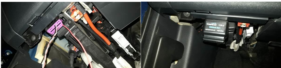
Joonis 9. OBD-II ühendusmooduli paigaldus testautole.
