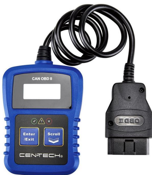
Joonis 5. OBD-II pistiku kaudu andmete lugemise seadme näide.
