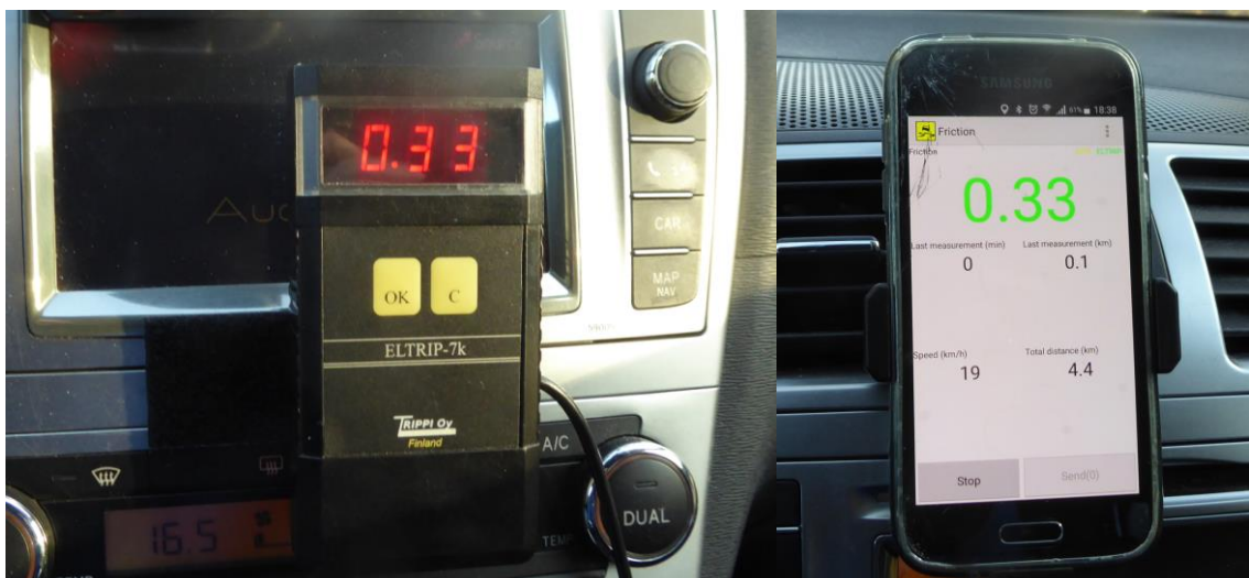
Joonis 8 Eltrip 7 paigaldus krõpsteibiga armatuurlauale andmeedastus Karedus äppi
