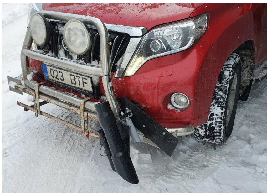
Joonis 3 Kaks optilist andurit suunatuna vasakusse rattajälge
