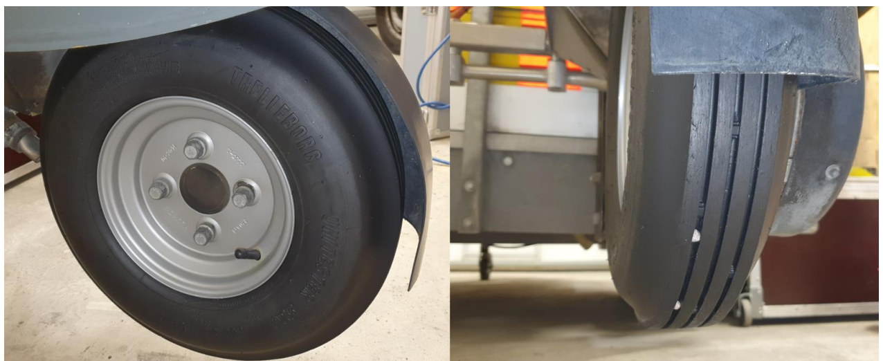
Joonis 2 Talvisteks mõõtmisteks ette nähtud rehvi Trelleborg T520 4.00-8
