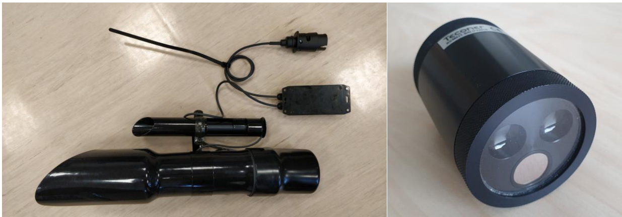
Joonis 4 Teconer Oy optilise anduri komplekt ja optilise anduri pea
