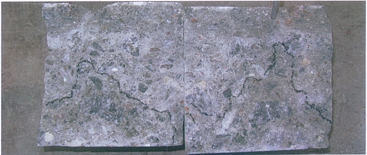
Foto 2. Lõhestatud katsekeha. Musta joonega on märgitud vee sissetungimissügavuse piir.
