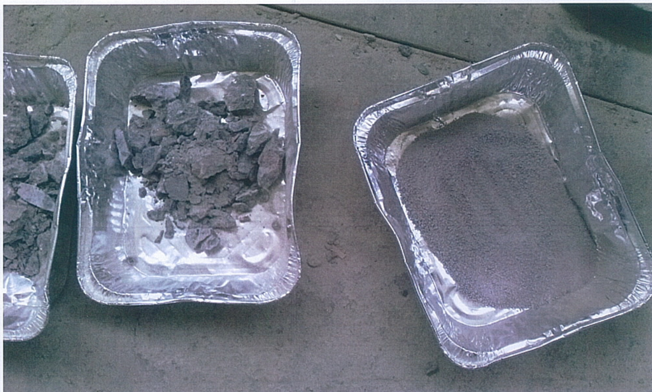
Foto 4. Purustatud ja peenestatud betoon.
