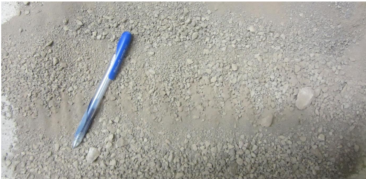
Joonis 9. Bituumenliiv pärast kuivsõelumist
