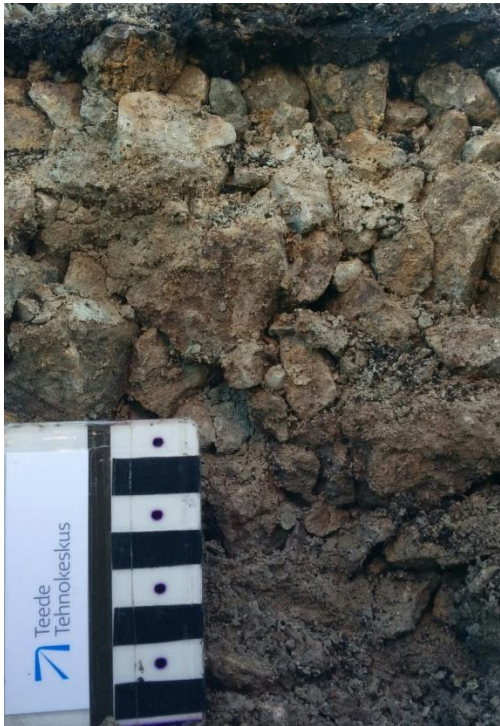
Foto 14. Vasakul fotol näha killustikukiht 17 cm, paremal bituumenliiv 5 cm
