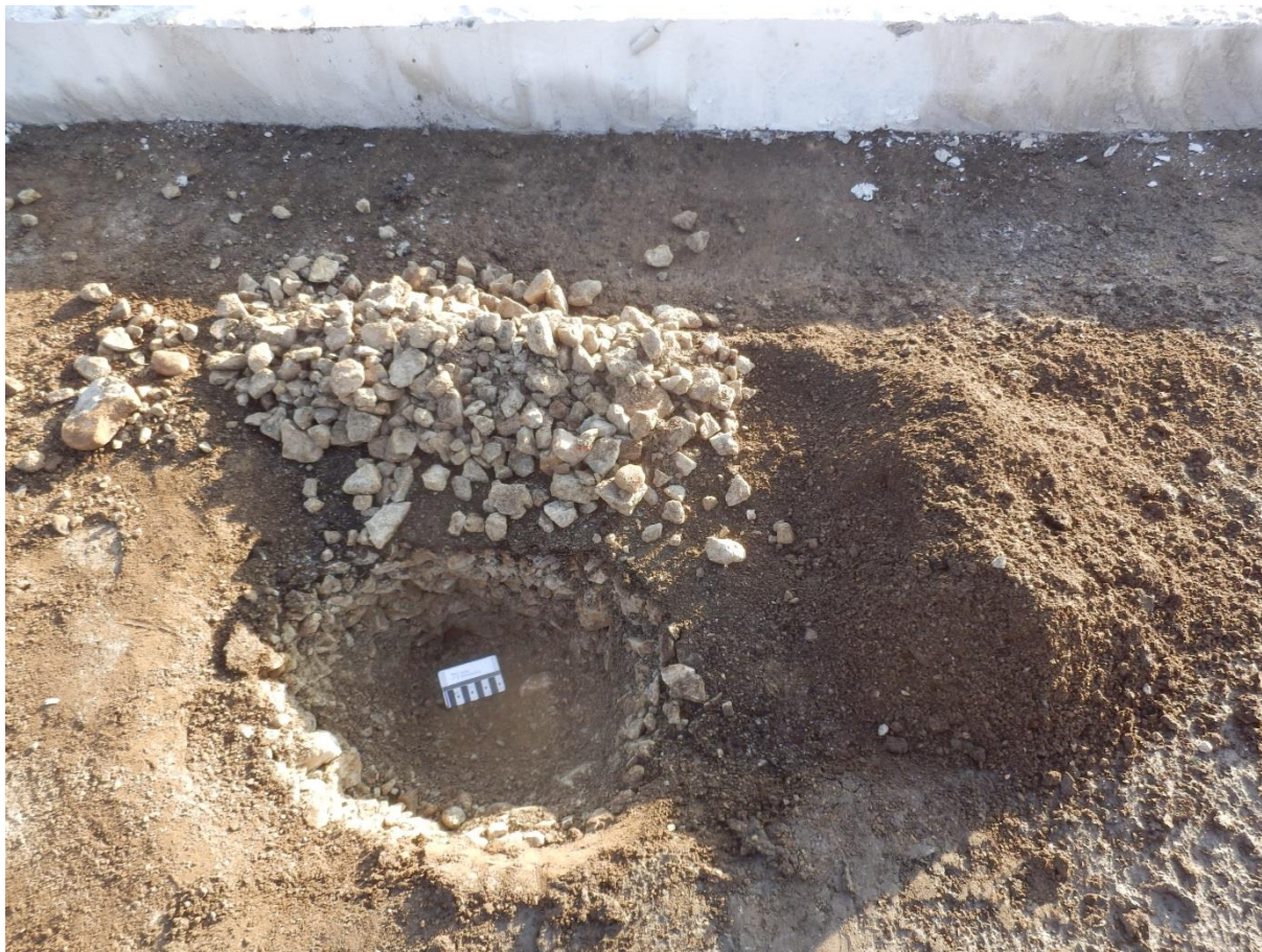
Joonis 11. Vaade väljaraide alusele surfile, kus näha bituumenliiv ja killustik
