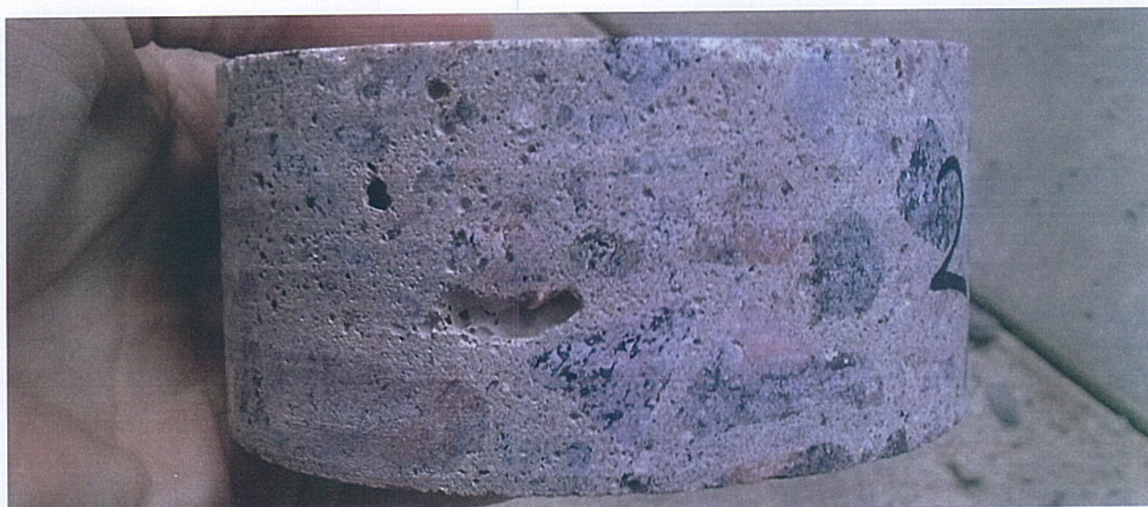
Foto 3. Puurkehast lõigatud 5 cm paksune silinder.
