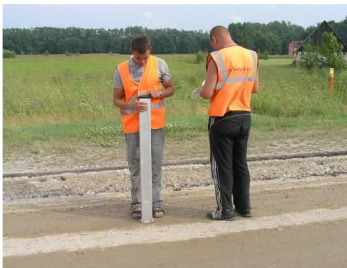
Pilt 3.1. Mõõtmiste teostamine INSPECTOR-2 seadmega
