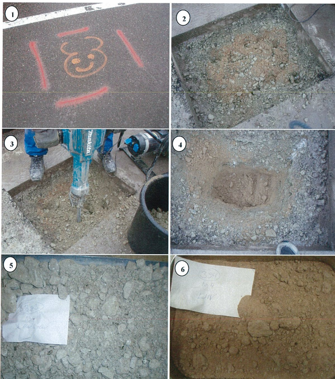
1- terve asfaltkate 2- killustiku-liiva segu 3- killustiku-liiva segu kihi avamine 4- avatud liivakiht 5- paekillustik peale kuivatamist laboris 6- liiv peale kuivatamist laboris
