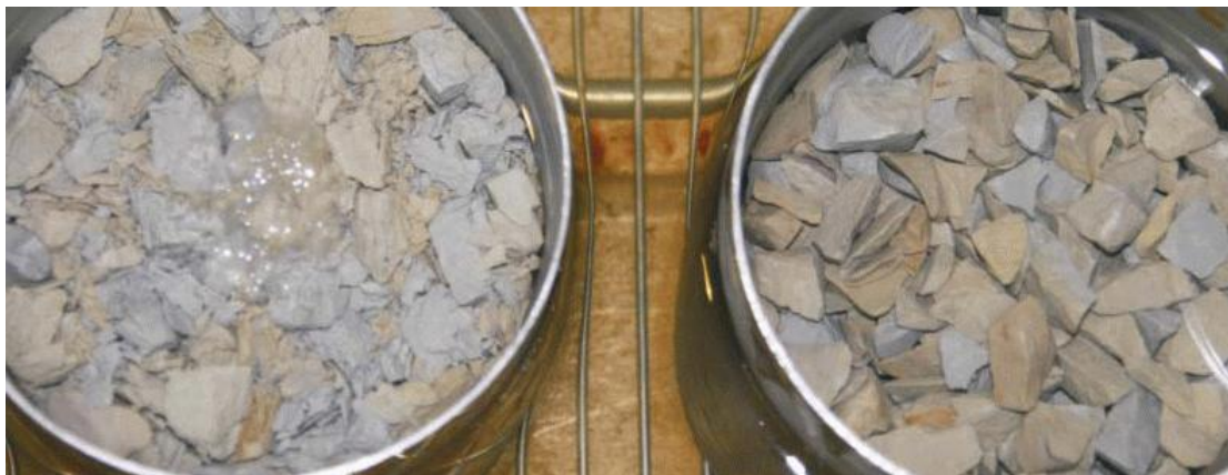
Joonis 9 Paekillustiku külmakindluse katsetulemused pärast 10 tsüklit NaCl lahuses ja vees
