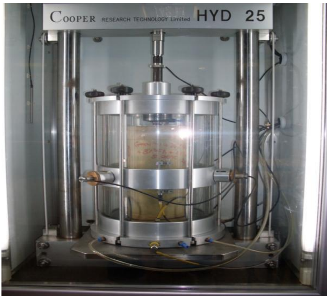
Joonis 12 Kolmetelgse tsüklilise koormamise katseseade
