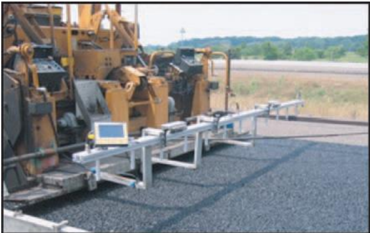
Joonis 3. Infrapuna anduritega varustatud mõõtelatt [3]
