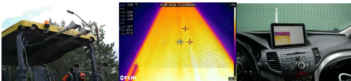
Joonis 7. Laoturile paigaldatud termokaamerad (vasakul), salvestatud termopilt (keskel) ja reaajas segu temperatuuride jälgimine distantsilt (paremal)
