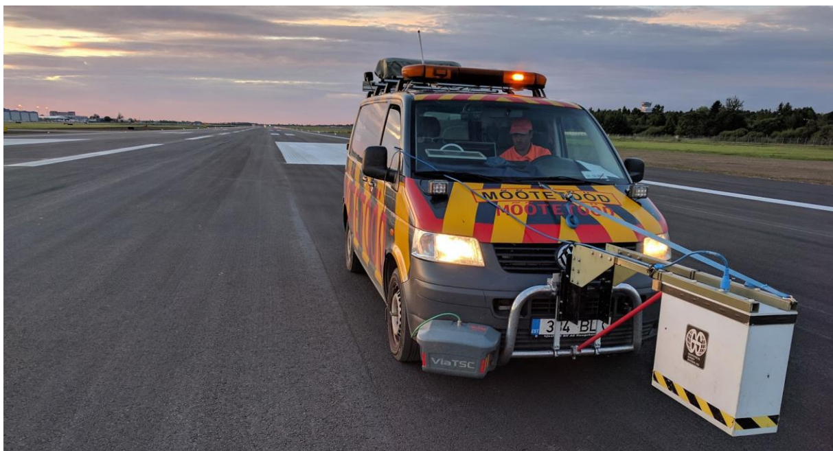
Joonis 11. AS Teede Tehnokeskus mõõtebuss GSSI SIR-30 maaradariga koos 1,0 GHz antenniga
