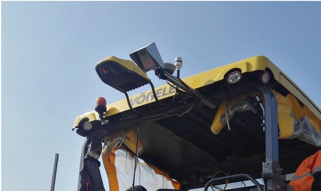
Joonis 14. Termograafilised seadmed RoadScan (vasakul) ja TGS (paremal)
