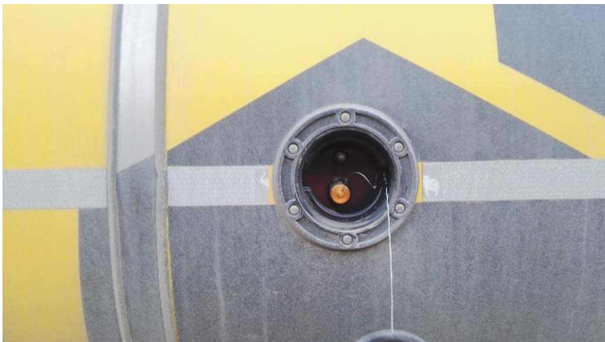
Joonis 10. Termokasti küljel asuv ava, mis võimaldab kontrollida kastis oleva materjali temperatuuri
