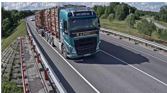
Foto 73. Sanga viadukt – 66,3 t [mõõtmiste 1. etapp]
