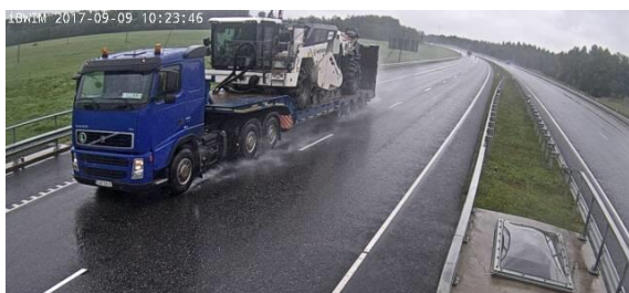
Foto 80. Piuga jalakäijate tunneli Tartu suund – 59,1 t [mõõtmiste 1. etapp]
