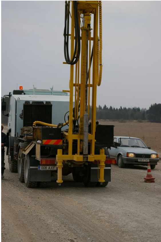
Foto 3.1. Puurkehade võtmine remondiobjektile maanteel nr. 15 Tallinn-Rapla-Türi
