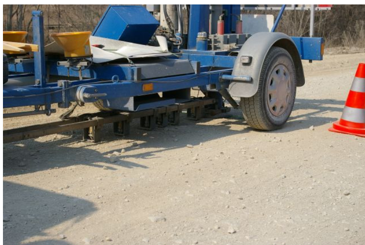
Foto 4. Teekonstruktsiooni kandevõime mõõtmine seadmega Dynatest FWD-8002
