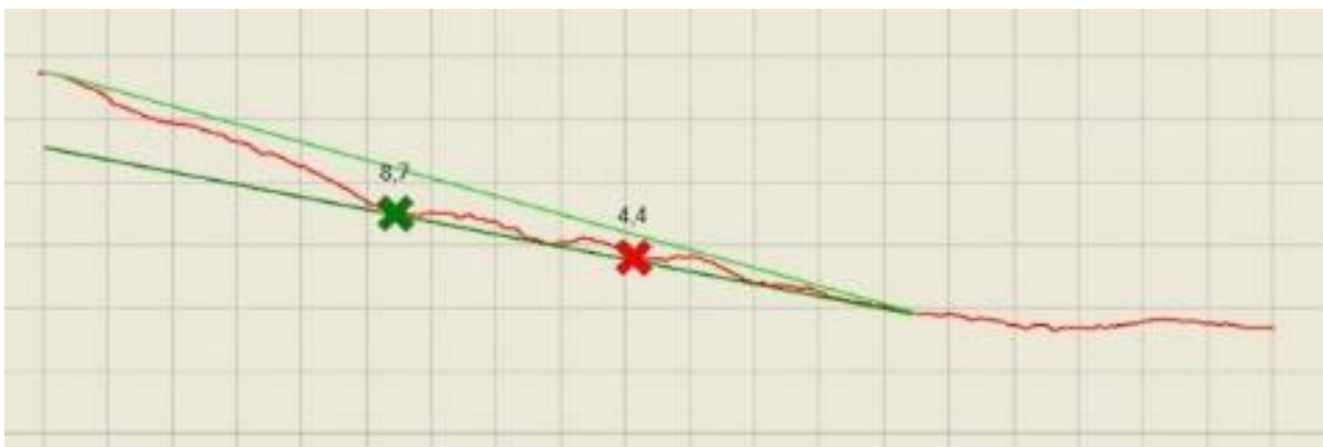
Joonis 45. Objekt 2_1_15 km 122,2, kausikujuline roobas viitab kandevõimeprobleemidele
