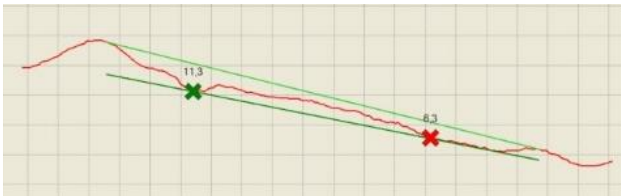
Joonis 44. Objekt 3_1_34, kus katte profiil viitab ülakihtide kandevoime-/deformatsiooniprobleemidele
