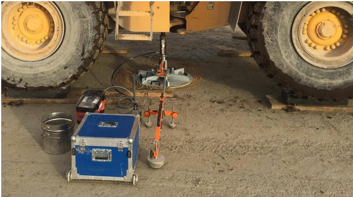
Joonis 1. Plaatkoormuskatse seade 762mm plaadiga ning vastukaal (rataslaadur)
