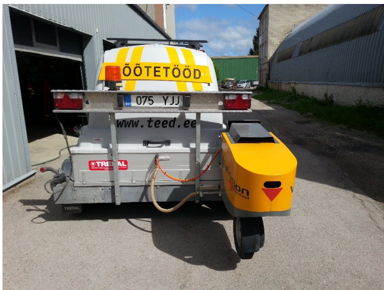
Joonis 1. Teekatte haardeteguri mõõteseade ViaFriction
