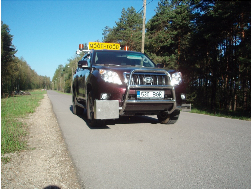
Joonis 2. Teekatte tekstuuri mõõteseade LTM-1
