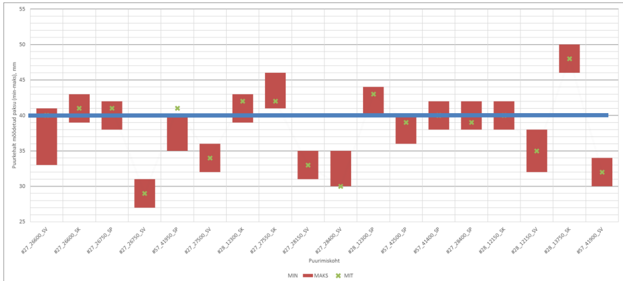
Joonis 32. Katte paksus kohtades, kus sama puurkehalt mõõdetud paksuste erinevus on üle 3mm
