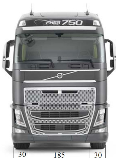
Joonis 25. Asfaldiveoki mõõtmed
