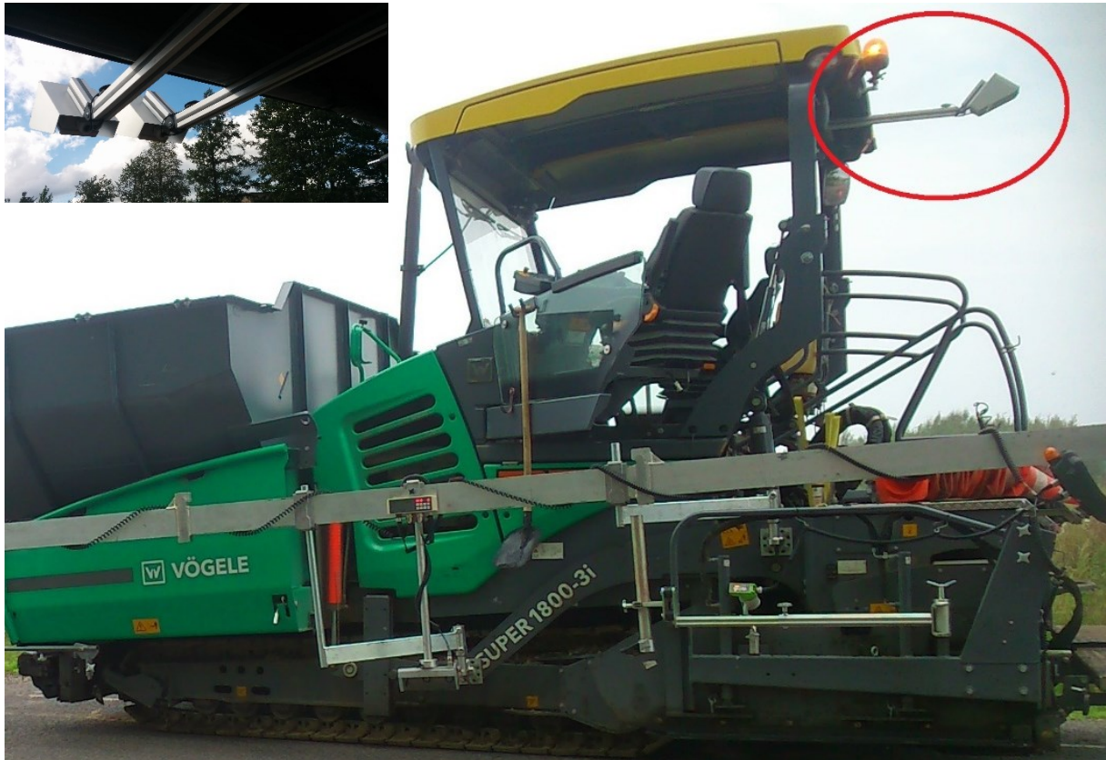
Joonis 69. Termograafiline süsteem TGS laoturil ja kaamerad
