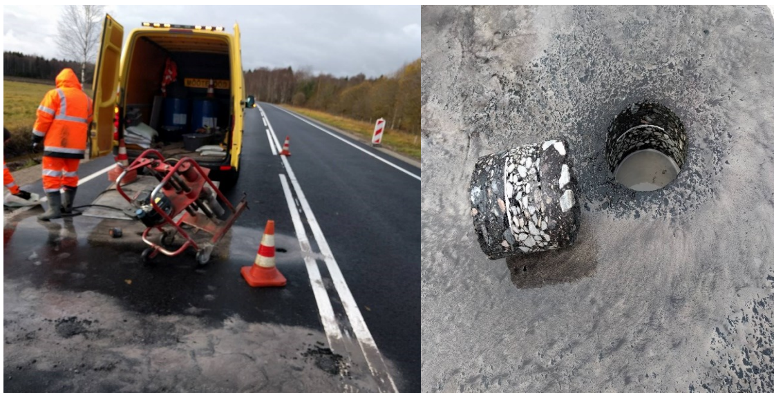
Joonis 73. Puurimine ning välja puuritud puurkeha
