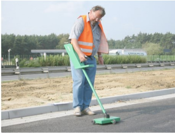
Joonis 2. Kattekihtide paksuse mõõtmine MIT-SCAN mõõteseadmega (vasakul). MIT-SCAN mõõteseadme juhtpaneel (paremal)
