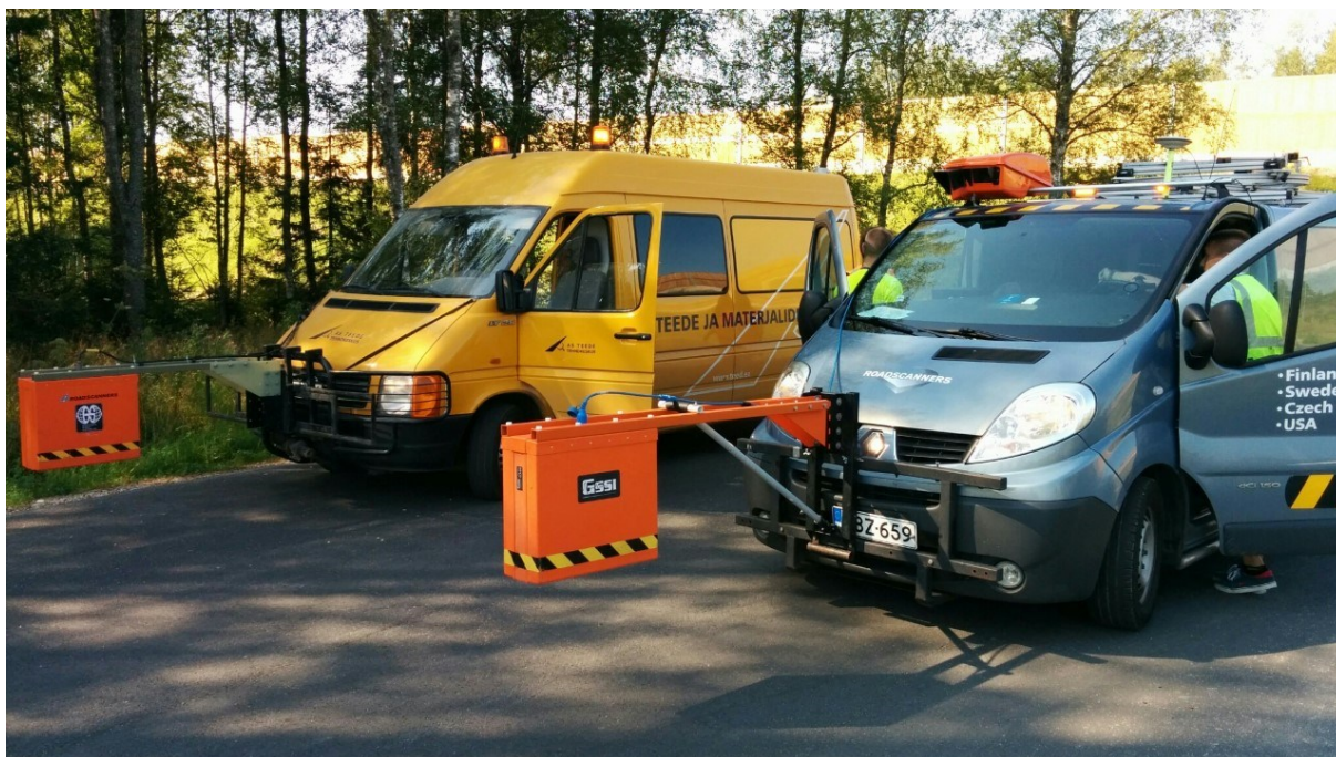
Joonis 71. Eesti ja Soome maaradarid kõrgsageduslike õhk-paar-antennidega
