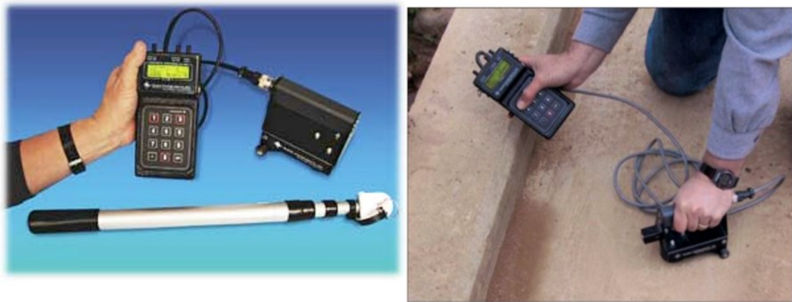
Joonis 7. CTG-1T seade (vasakul). Betoonikihi mõõtmine CTG-1T seadmega (paremal)
