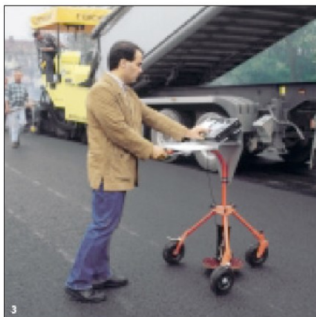
Joonis 3. Mõõtmiste teostamine Isoscope MP30 seadmega mõõteraami pealt (vasakul). Kihtide paksuste mõõtmine käsiseades (paremal).
