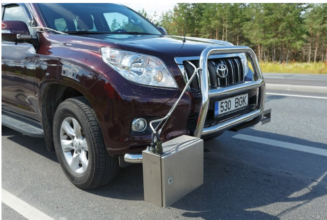
Joonis 72. Lasertehnoloogial põhinev tekstuuri mõõteseade MPD mõõtmiseks
