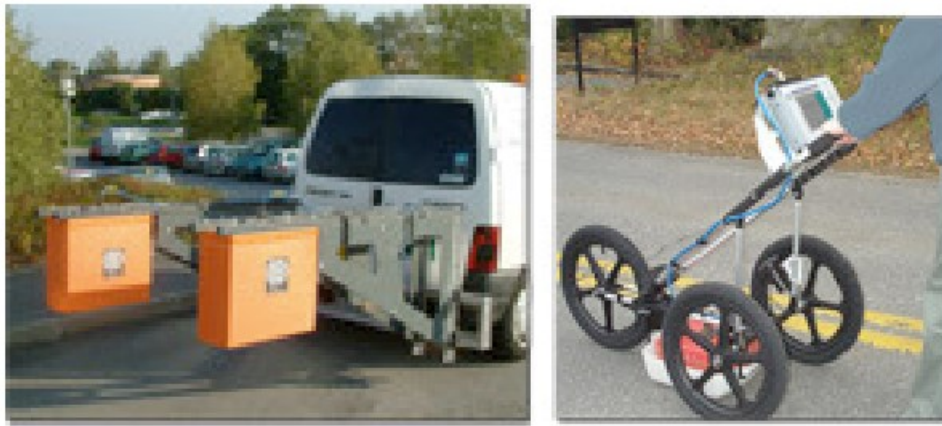
Joonis 18. GSSI maaradari õhk-paar antennid (vasakul). Maapaar-antenniga varustatud maaradar (paremal)
