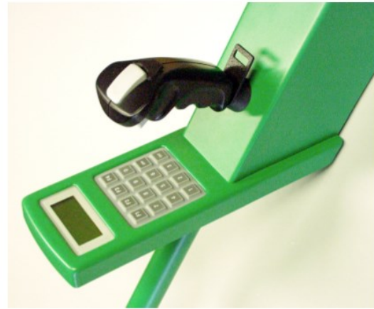
Joonis 2. Kattekihtide paksuse mõõtmine MIT-SCAN mõõteseadmega (vasakul). MIT-SCAN mõõteseadme juhtpaneel (paremal)
