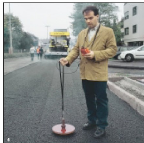
Joonis 3. Mõõtmiste teostamine Isoscope MP30 seadmega mõõteraami pealt (vasakul). Kihtide paksuste mõõtmine käsiseades (paremal).
