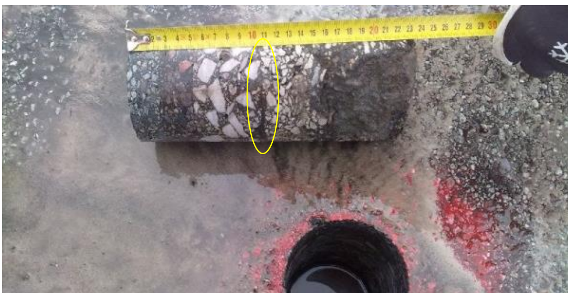
Joonis 23. Puurkeha B2 polüestervõrguga HaTelit
