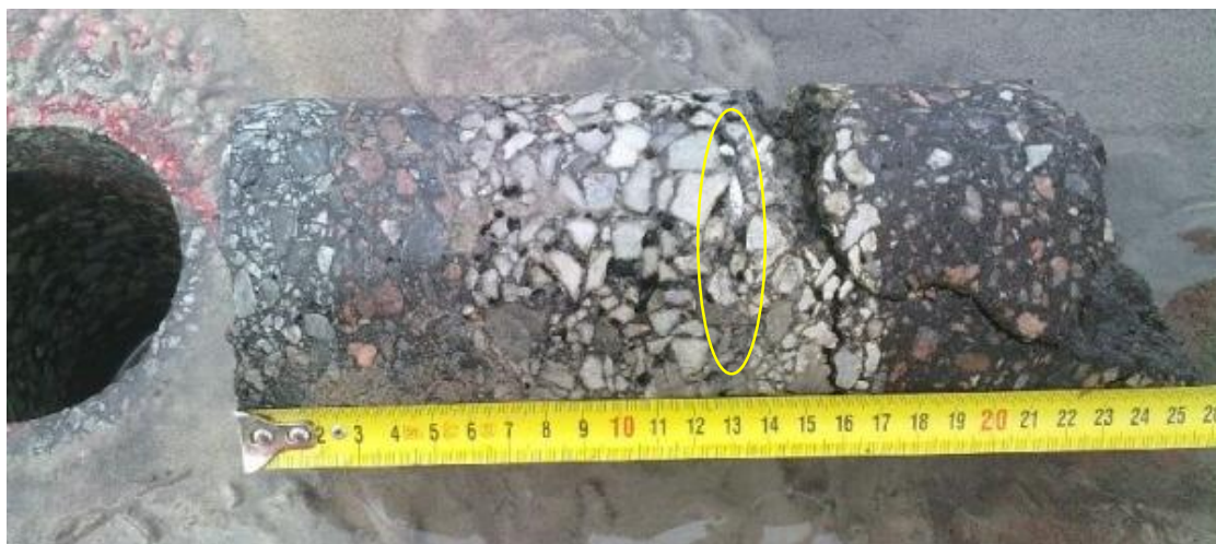
Joonis 24. Puurkeha A1 terasvõrguga lõigul
