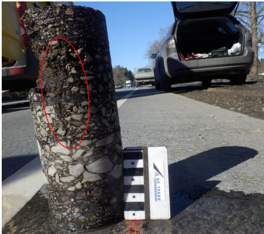
Joonis 29. Pragu vanas kattes (2010), mis ei ole 2013 üles tulnud
