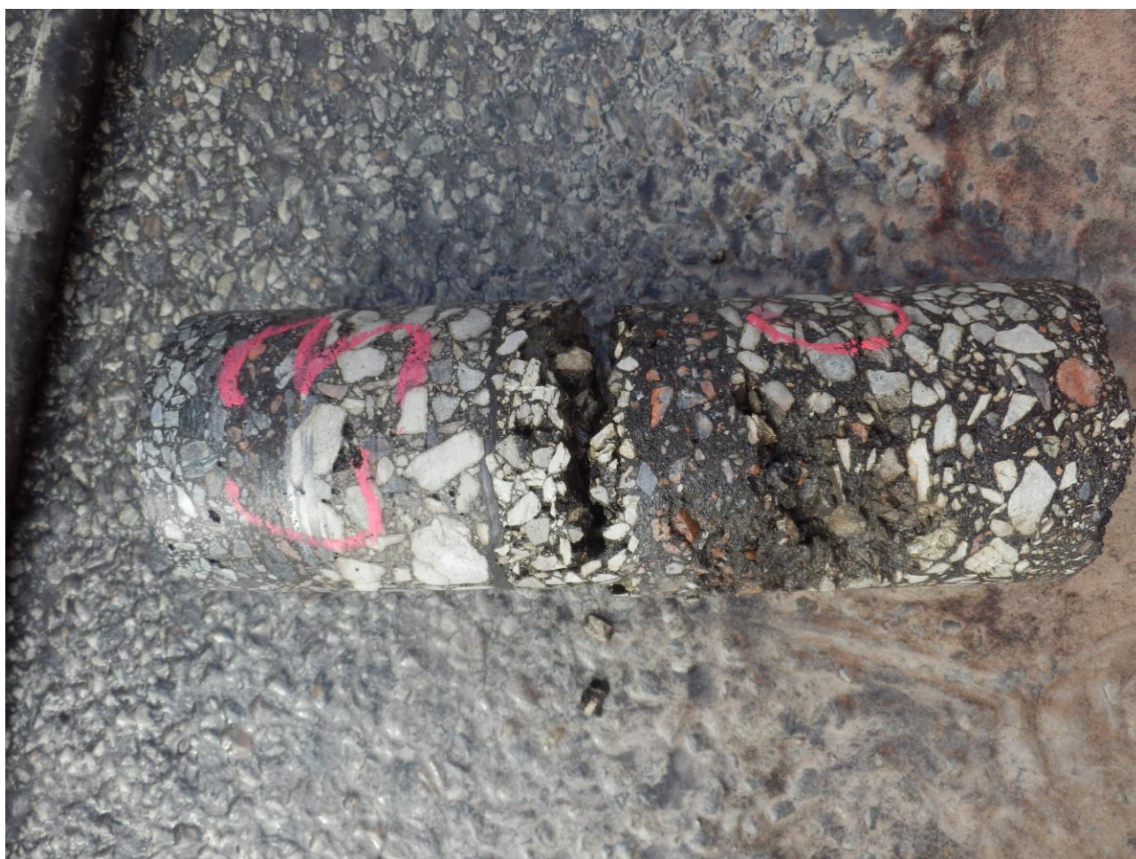
Foto 8. Pragu 1 kohas klaaskiudvõrguga lõigul (võrk on kinni, purunemine PAB-kihis)
