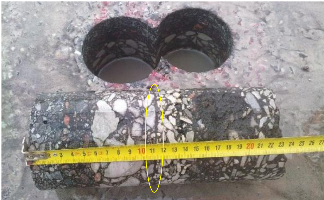
Joonis 22. Puurkeha C1 klaaskiudvõrguga Glasstex
