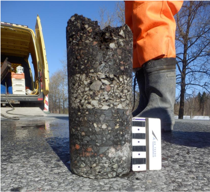
Foto 3. Puurkärn asfaldivõrguta lõigult, kohas R3
