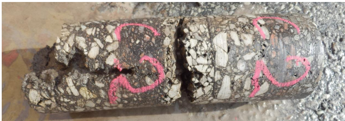
Joonis 33. Vana katte alusekihi lagunemine
