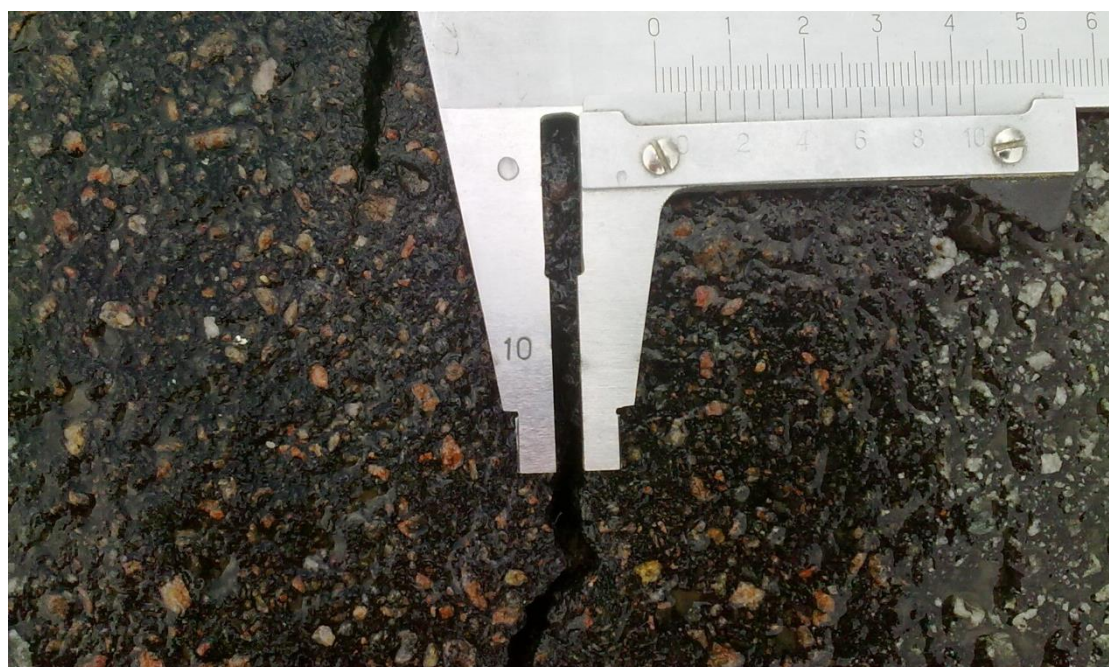
Joonis 17. Prao laiuse (kuni 4 mm) mõõtmine prao 1 juures
