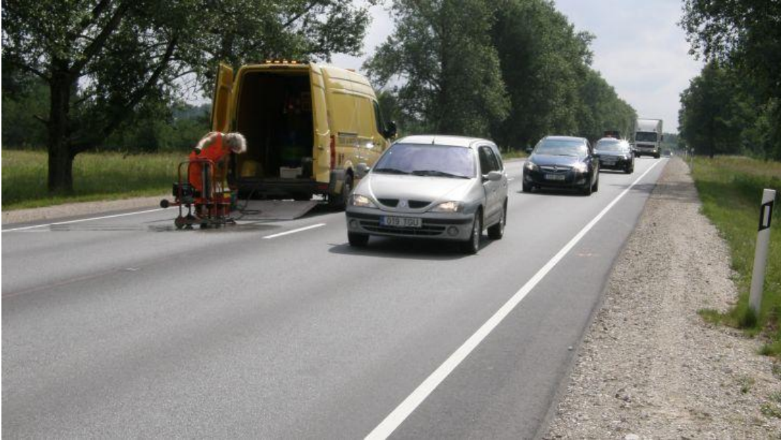
Foto 1. Katte pragude uuringud puurimismeetodil 2011
