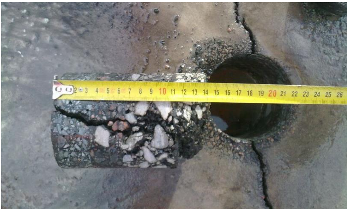
Joonis 21. Puurkeha on poolitatud prao poolt nii võrgust (terve) üleval- kui allpool
