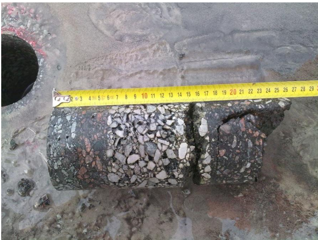
Foto 5. Pragu pole üles levinud kuid järgi on andnud poorne lubjakivi baasil aluskiht 2012
