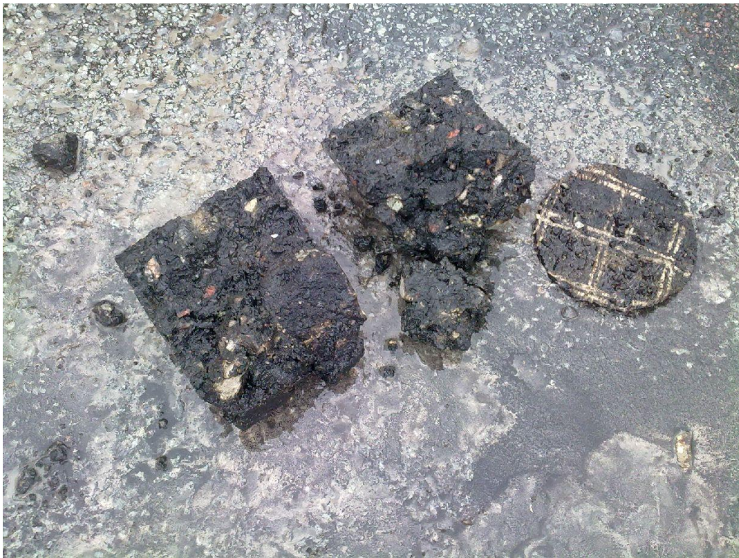
Foto 3. Prao poolt poolitatud suurkeha ja terve Glasstex asfaldivõrk 2012
