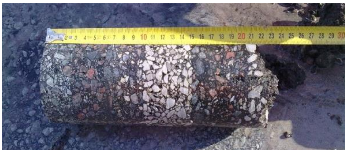
Joonis 25. Puurkeha R1 võrguta lõigul
