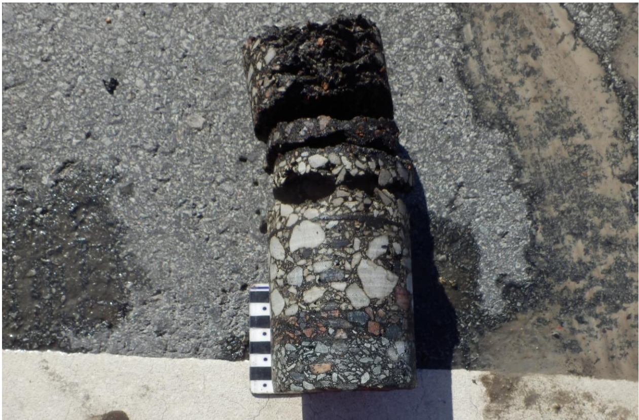
Foto 9. Puurkärn klaaskiudvõrguga lõigul kohas C3
