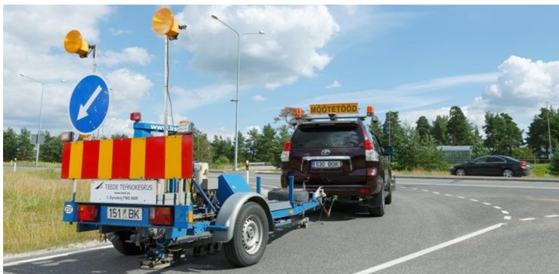
Joonis 7. Kandevõime mõõteseadme Dynatest FWD 8002
