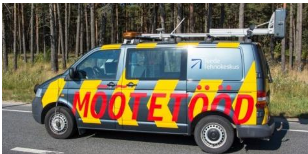
Joonis 8. Multifunktsionaalne mõõtesead – profilograaf
