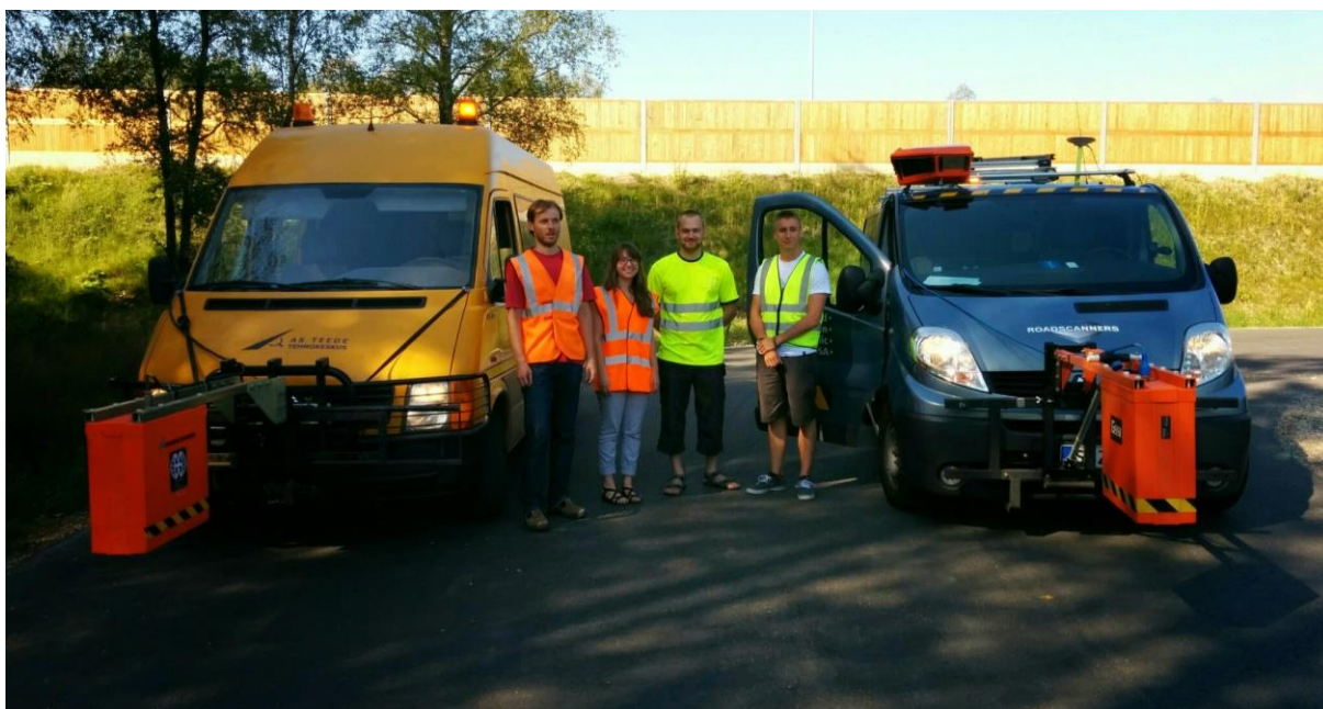
Joonis 2. Mõõtjad GSSI kõrgsageduslike (2,0 GHz) õhkpaar-antennidega
