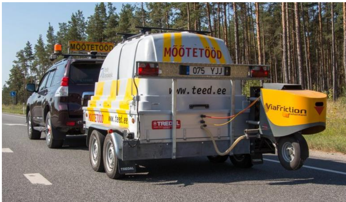
Joonis 10. Haardeteguri mõõteseadet ViaFriction
