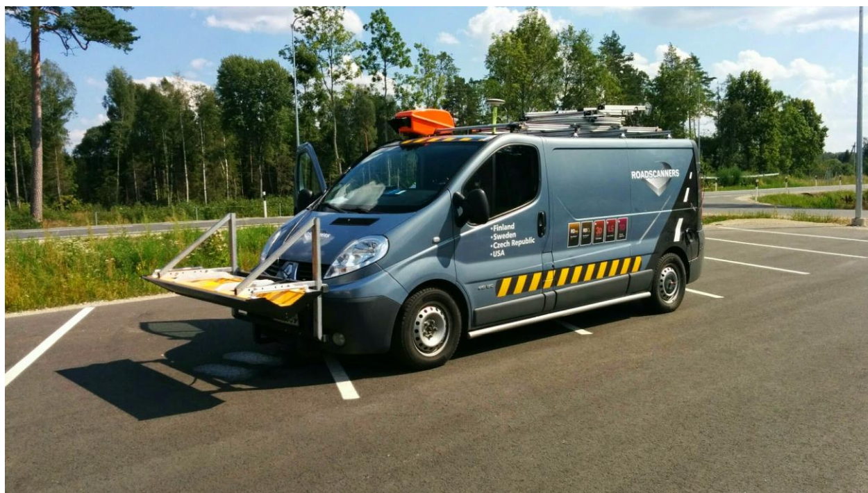
Joonis 29. 3d-radar Geoscope Mark IV
