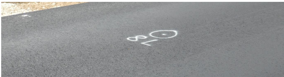
Joonis 24. Külma koha tähistamine (8 L) kattel proovi võtmiseks
