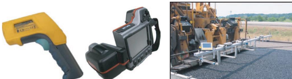
Joonis 4. IR-termomeeter, IR-kaamera ja IR-anduritega mõõtelatt
