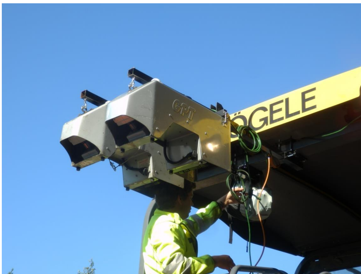
Joonis 10. Termoskaneerimise seadmed GPTux 34
