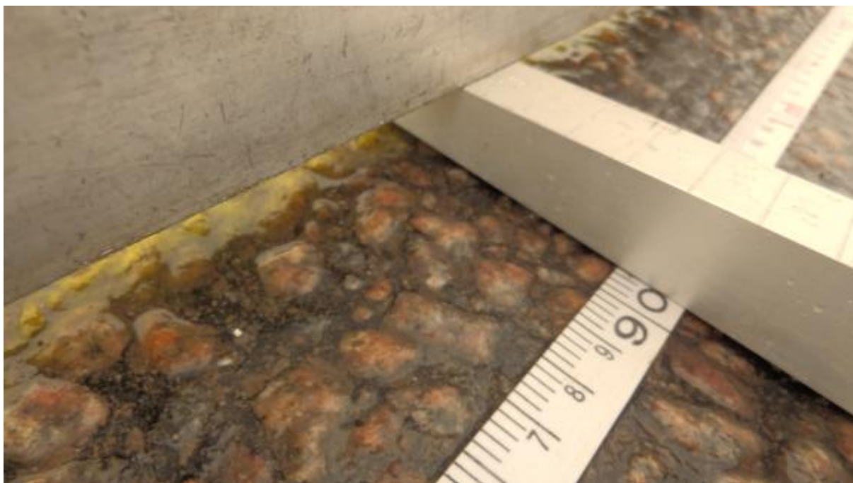
Foto 2. Tee põiktasasuse mõõtmine lati ja kiiluga
