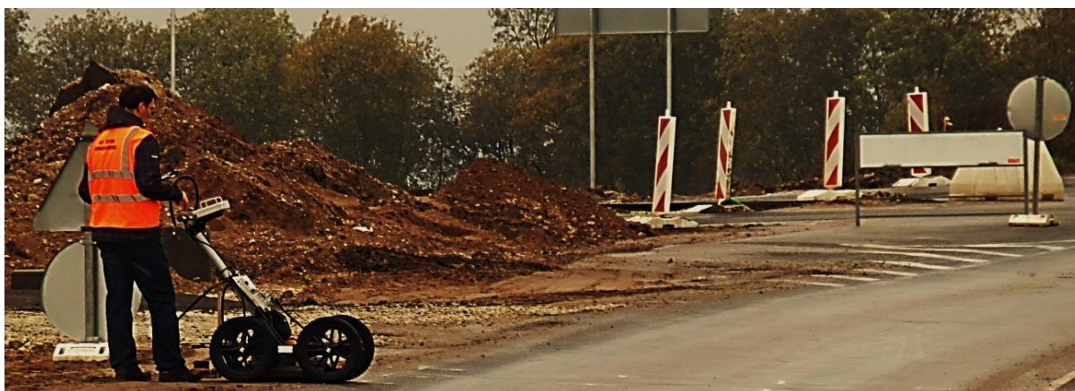
Foto 5. Tarindikihtide mõõtmised maaradariga
