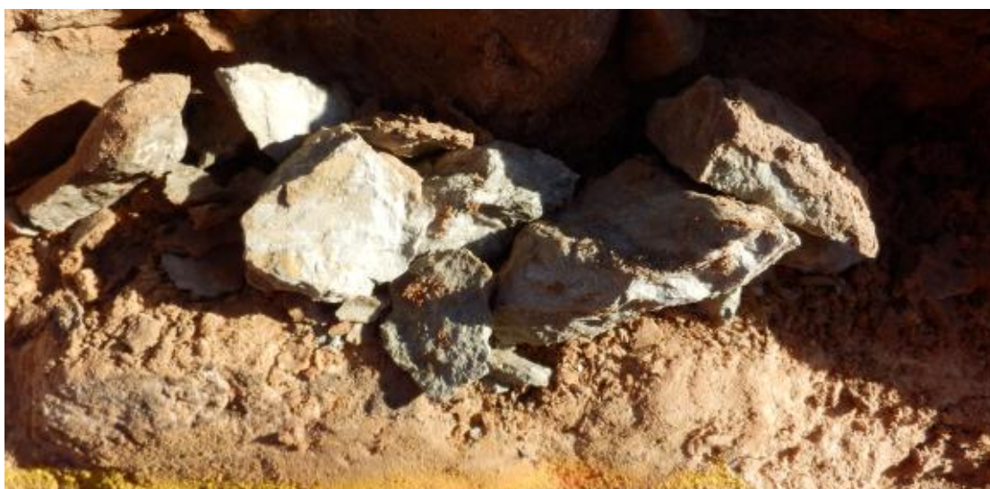
Foto 19. Kihis koos püsinud kuid kihist eemaldamisel laialilagunenud kivi
