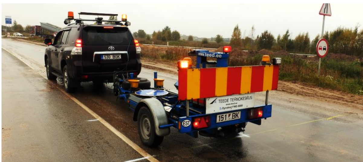
Foto 4. Kandevõime mõõtmine objektil
