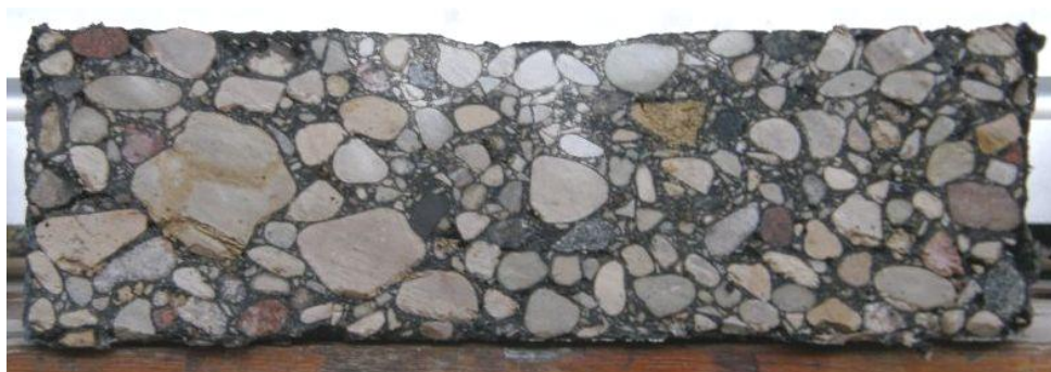
Joonis 30. AC 32 base C0/100 deformatsioonikindluse katse proovikeha ristlõige pärast katset
