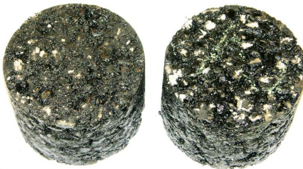
Joonis 8. Vasakul tihedam, täielikult ümaratest teradest AC 32 base segu ja paremal poorsem C 50/10 segu
