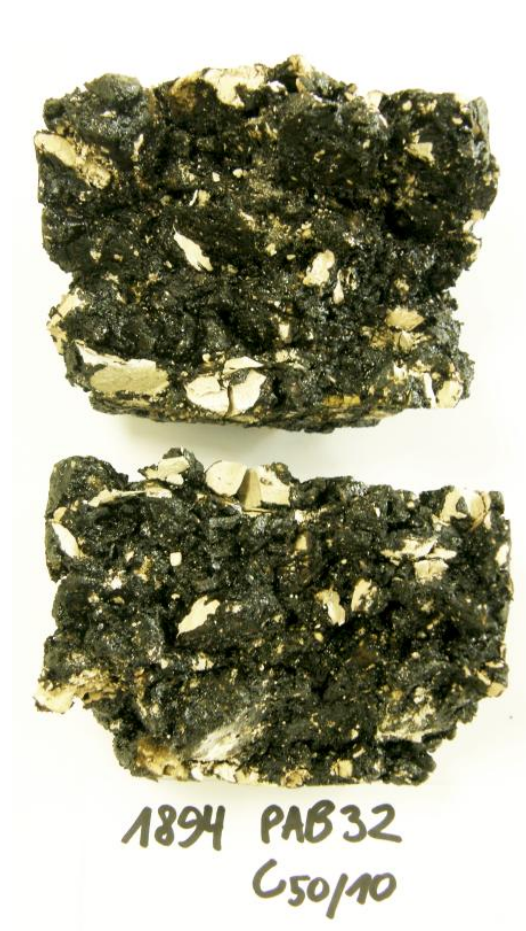
Joonis 34. P32-50/10 (AC32 50/70 C 50/10 ) murdumispind (Marshalli katse)
