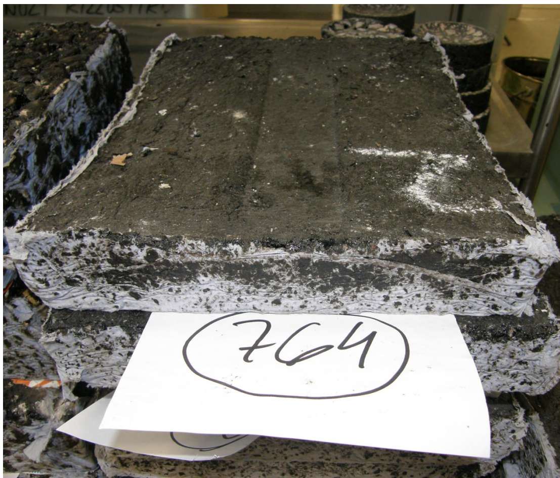
Joonis 32. Deformatsioonikindluse katse proovikeha pärast katset (AC-50)
