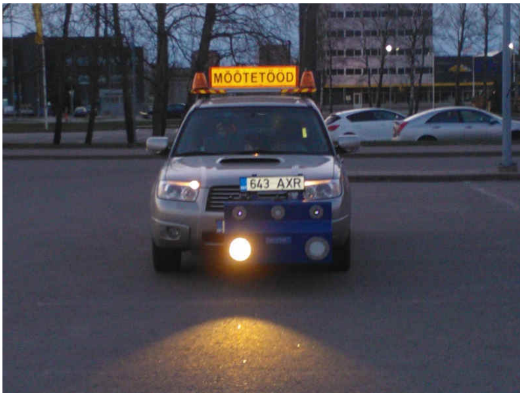
Joonis 2. Mõõtesõidukile paigaldatud mõõteseadet RetroTek-M™
