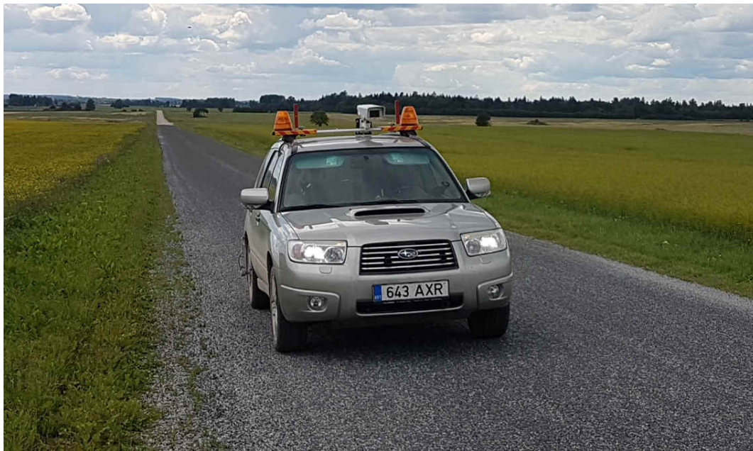
Joonis 6. Sõidukile paigaldatud teekattemärgistuse inventeerimiseks kasutatud pildistamisseade
