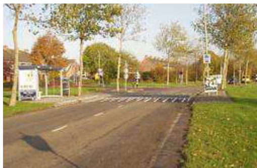
Liikluse rahustamine bussipeatuse juures asuva nn lamava politseinikuga
