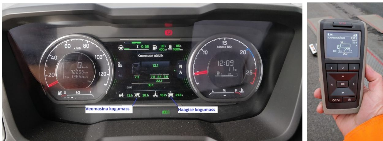
Joonis 19 „Scania 04 metsaveok 4+“ sõiduki näidikutepaneel (vasakul) ja Volvo koormusnäidik (paremal)
