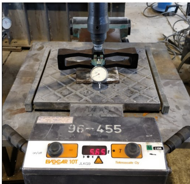
Joonis 18. Teljekoormuskaalude kontroll Teede Tehnokeskuse laboratooriumis.
