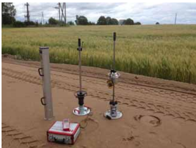
Seadmed, millega mõõdetakse objektidel liiv- ja kruuspinnase kandevõimed
