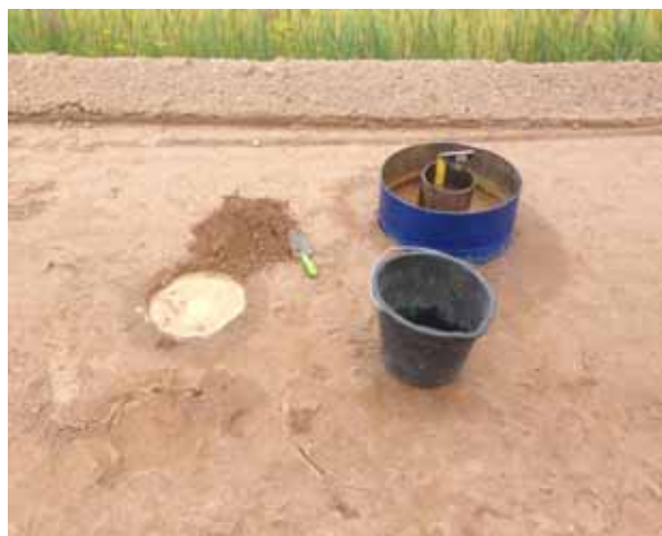
Seadmed, millega mõõdetakse objektidel liiv- ja kruuspinnase kandevõimed
