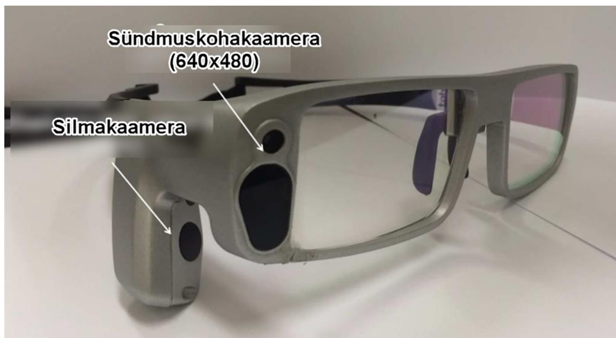
Joonis 4 Uuringus kasutatud katseseade Tobii Eye Tracking
