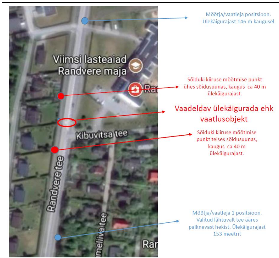
Joonis 6. Vaatluste teostamise tehniline kirjeldus
