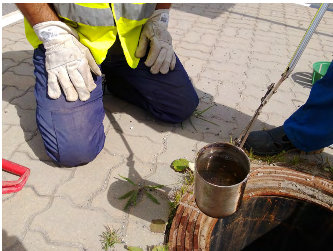
5 Sademevee kollektorkaevu 3 vesi ja pinnas olid reostustunnusteta
