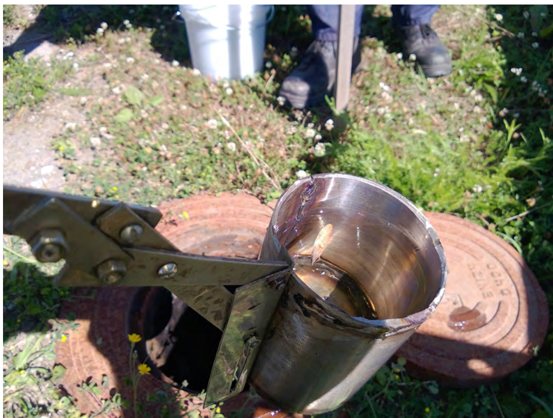
12 Sademevee kollektorkaev 12 oli veega uputatud, vesi reostustunnusteta, sete praktiliselt puudus
