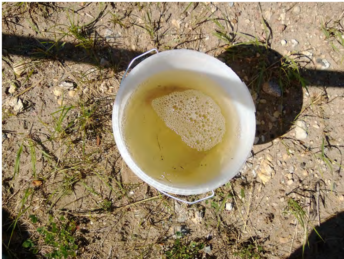
18 Sademevee kollektorkaevu 16 vesi oli halli varjundiga, naftasaaduste lõhna polnud
