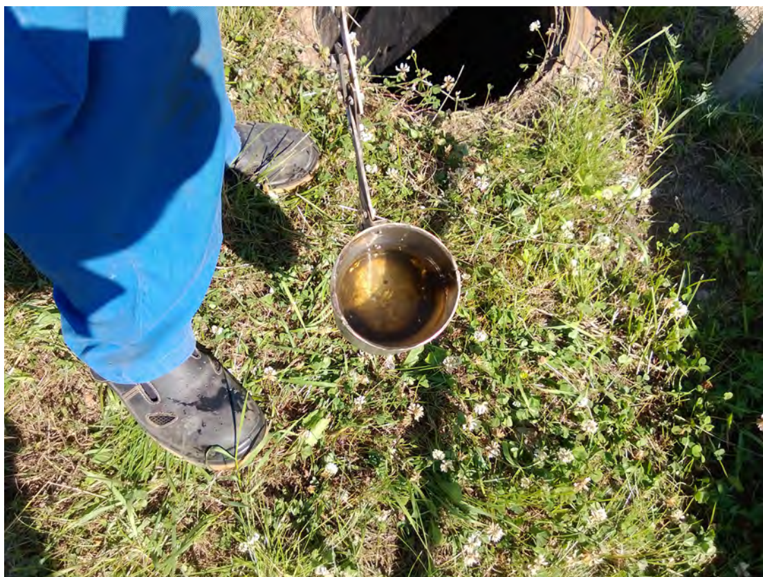
16 Sademevee kollektorkaevu 15 vesi oli otseste reostustunnusteta
