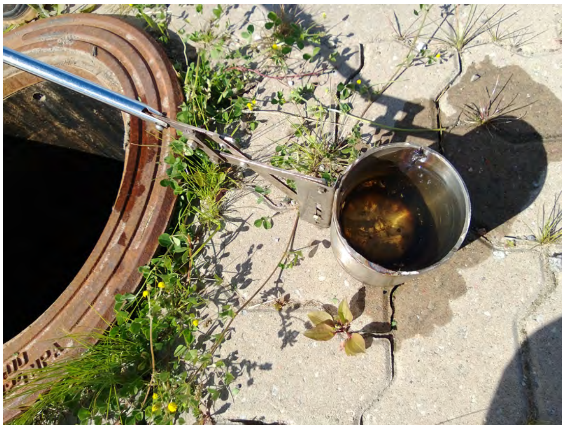
4 Sademevee kollektorkaevu 2 vesi ja pinnas olid reostustunnusteta
