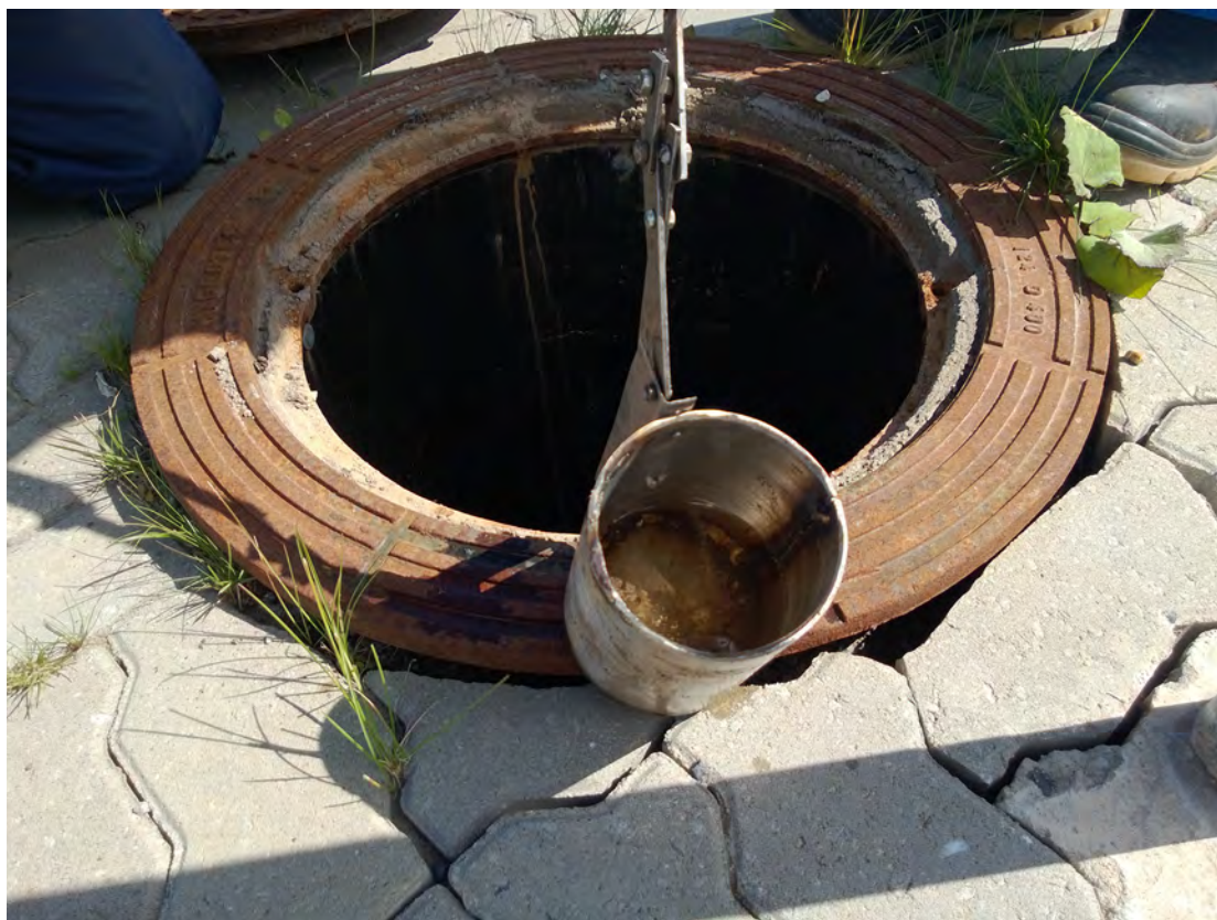
6 Sademevee kollektorkaevu 4 vesi oli reostustunnusteta, setet väga vähe
