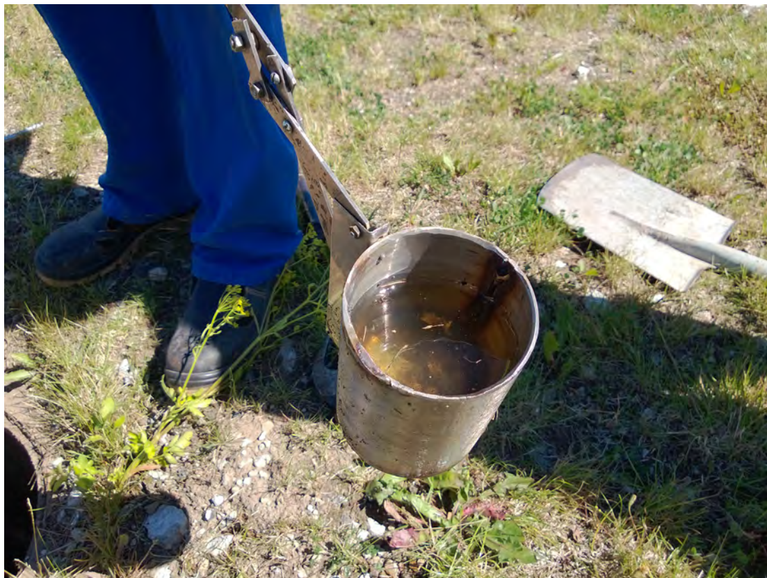
7 Sademevee kollektorkaevu 6 vesi oli hallikas, pinnas olid reostustunnusteta
