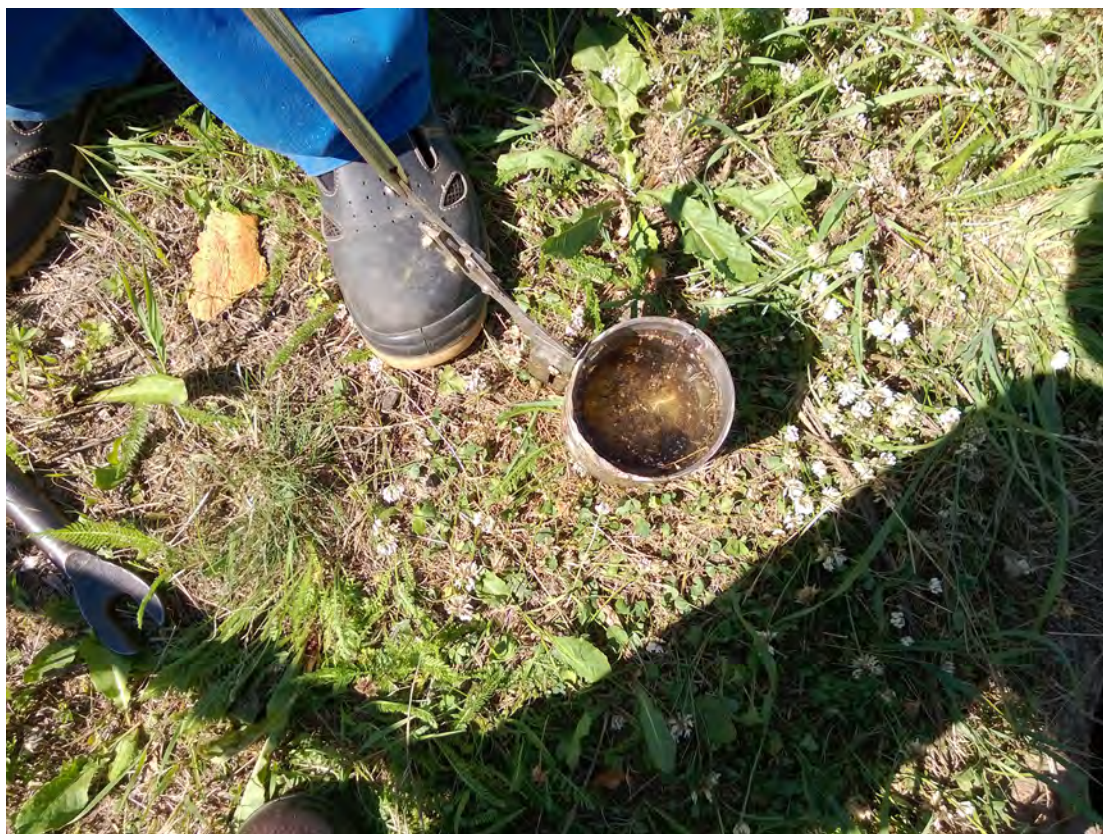
10 Sademevee kollektorkaev 11 oli veega uputatud, vesi reostustunnusteta, sete praktiliselt puudus
