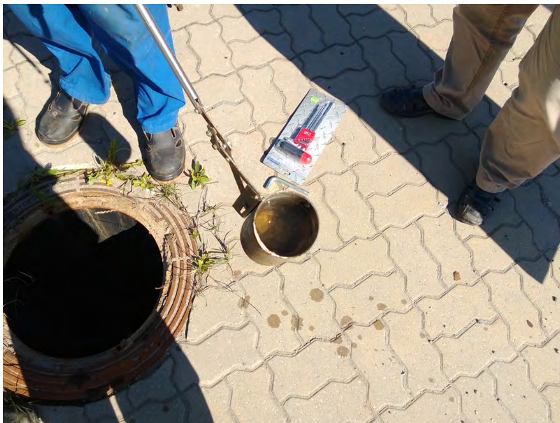
2 Sademevee kollektorkaevu 1 vesi ja pinnas olid reostustunnusteta
