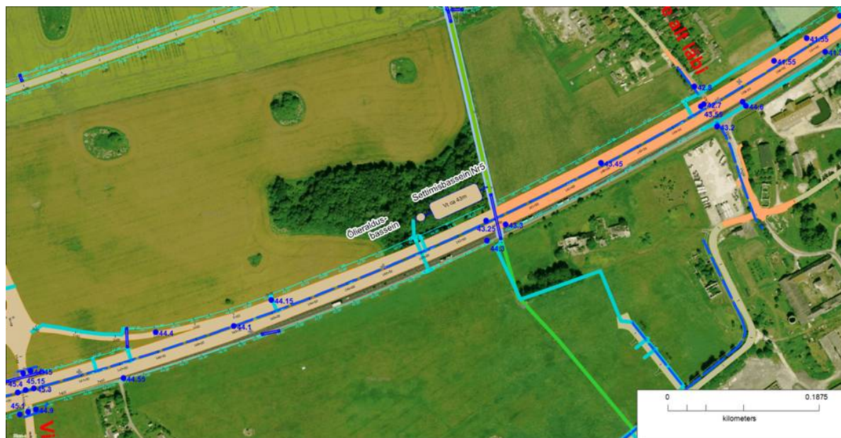
Joonis 6 Settebassein SB-5 on suurima arvutusliku koormusega, kõrval on koht loduks
