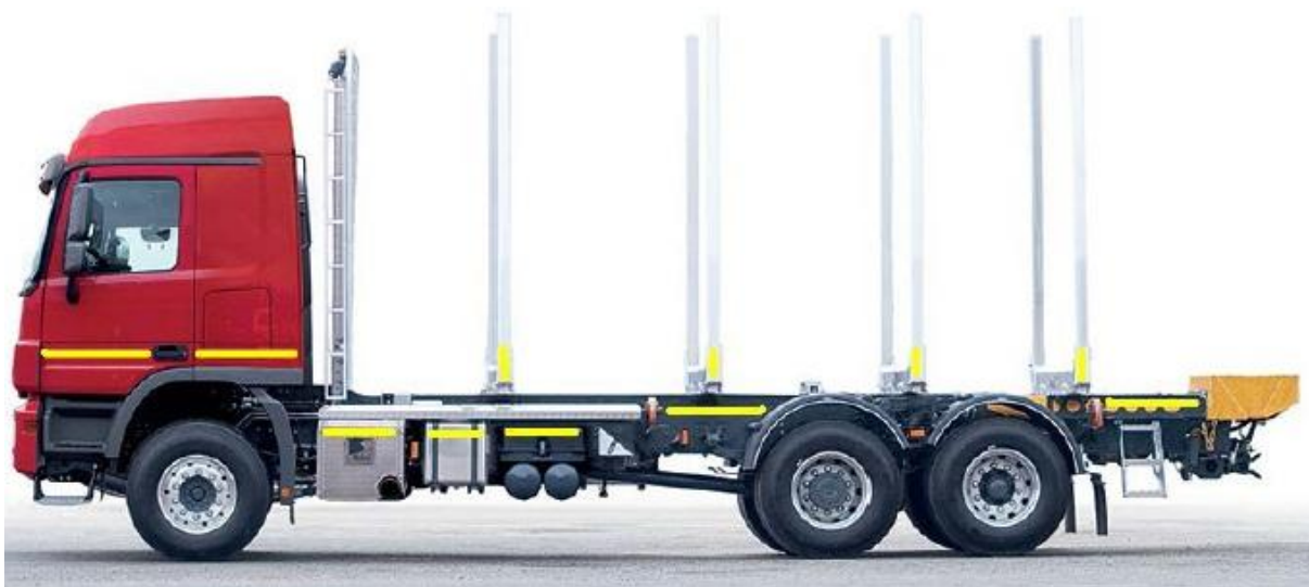
Joontähistusega kaetud raskeveok, mille konstruktsioon ei võimalda tähistus ühes sihis paigaldada, lahendus korrektne
