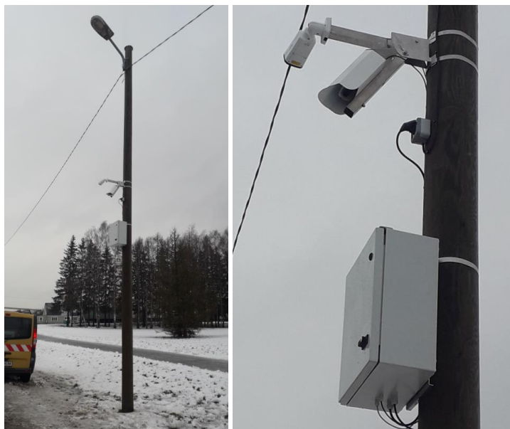
Joonis 16. Teeilmajaam ja teekaamera „Järva-Jaani“ paigaldatuna tänavavalgustuse postile
