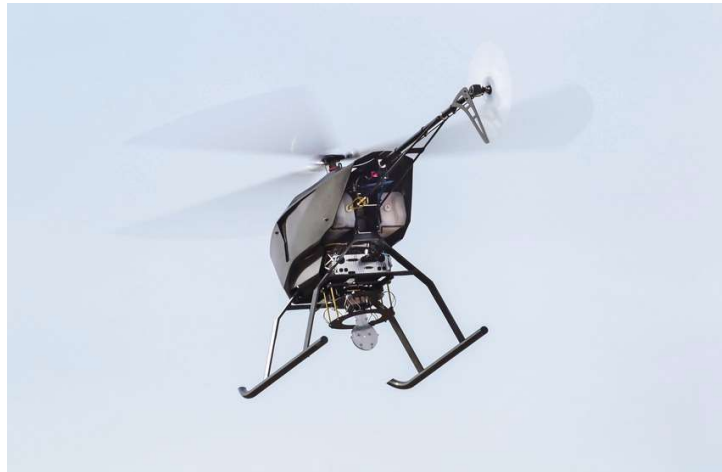
Joonis 4. Hepta Airborne autonoomne kaugseiredroon [7]
