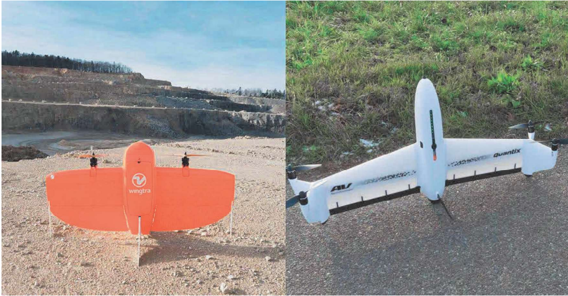
Sele 14. WingtraOne ja Aeroenvironment Quantix kõrvuti piltidel
