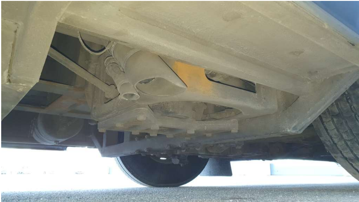
Joonis 2. Teeseisundi mõõteseade sõidukile paigaldatuna
