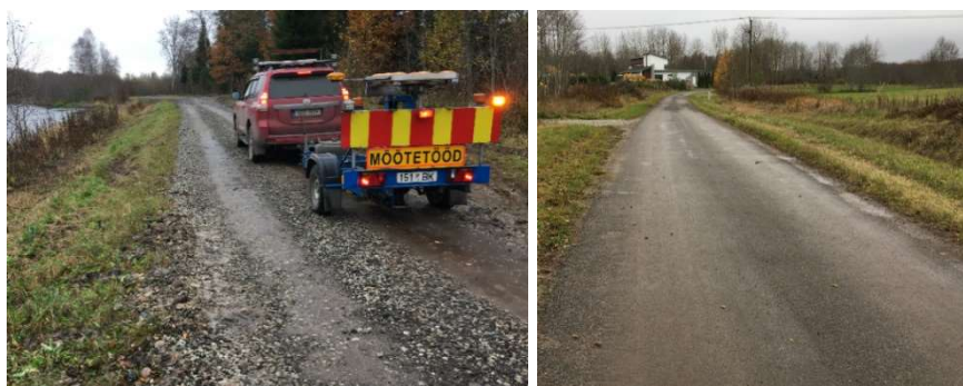
Fotod 3.10 ja 3.11. Veskitaguse tee oli nõrga kandevõimega kruusatee, mille katteks oli freespuru. Mõned mõõtepunktid võeti ka pinnatud sektiioonidelt.
