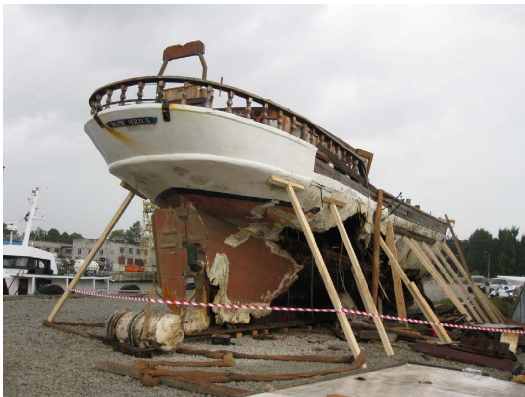
Foto 4 Purjelaev Blue Sirius parema parda laevakere vigastused
