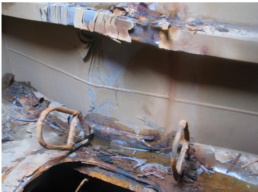
Foto 3 Parema parda vigastused ballasttankis nr. 3
