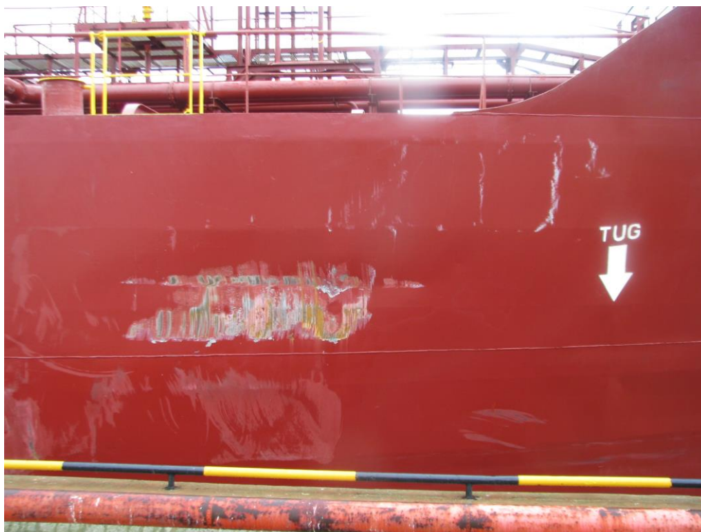
Foto 4 Parema parda välised vigastused
