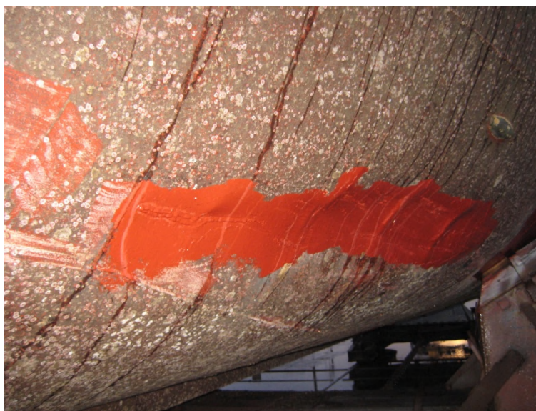
Foto nr 4 Kalalaev ERMISTU laevakere vigastused (mõlgid laevakere paremal pardal)
