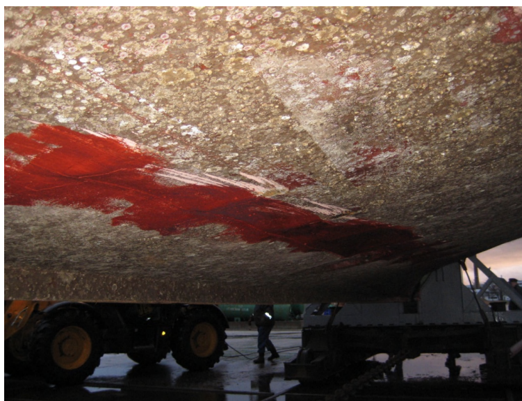
Foto nr. 3 Kalalaev ERMISTU laevakere vigastused (mõlgid laevakere põhjal)
