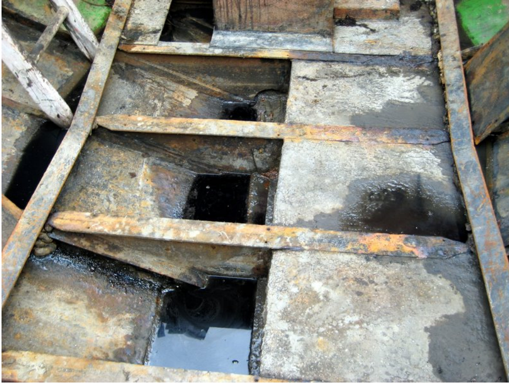
Kinnisballast (foto on tehtud vööri poolt)
