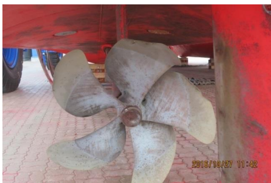
Foto 1 Reisikatomaraan Runö vasaku sõukruvi vigastused
